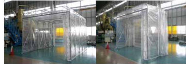
●粉塵飛散対策用ブース 水平タイプ ・カーテン/固定張テント ・固定スパン（1m） ・糸入り透明 / 帯電防止 ・W:4.3m×L:5m×H:3m
