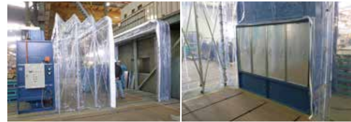
●粉塵対策用ブース 水平タイプ ・オープン/固定張りテント ・ハイパーカーテン耐熱透明 0.3mm厚 ・W:5.8m×L:3m×H:3m×2 台連結 片側を集塵機に固定
