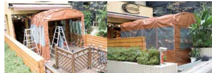
●飲食ブース アーチタイプ・特注巻き上げカーテン/オープン ・特注ターポリン生地 ・透明窓付き ・W:3.3m×L:4m×H:2m
